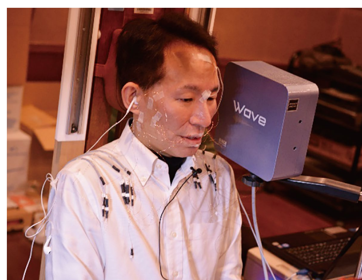
磁気計測装置による舌運動の計測
